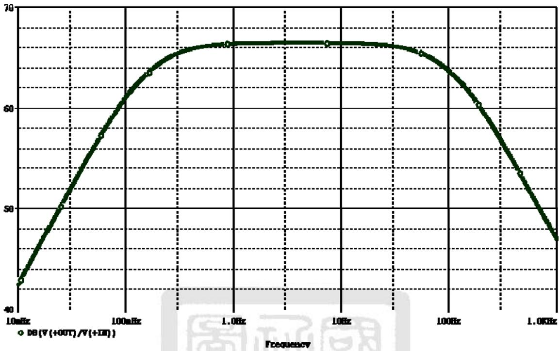
圖 3.9 心電圖擷取系統的頻率響應圖
